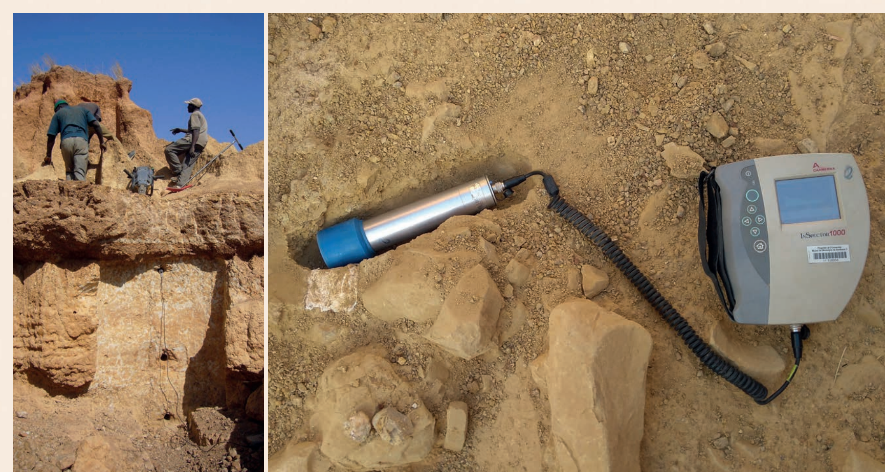
Figure 5 Des mesures de l'énergie libérée par la radioactivité naturelle sont faites sur le terrain en insérant la sonde d'un spectromètre (à droite) dans les coupes stratigraphiques.
