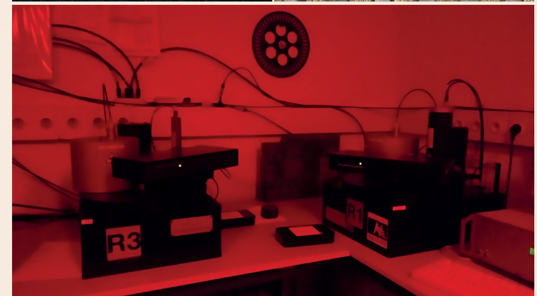
Figure 4 Avec l'OSL, il est possible d'analyser les grains de quartz un par un, un laser venant les stimuler individuellement pour libérer et mesurer l'énergie stockée dans chacun.
