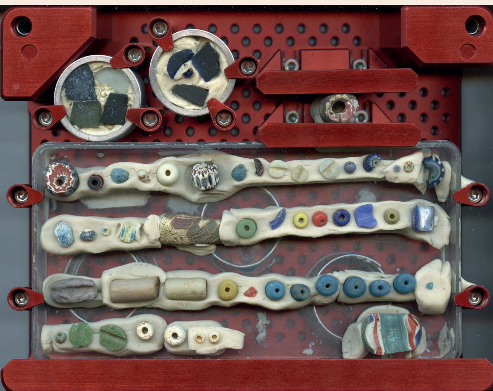
Figure 3 Configuration de la cellule pour l'analyse chimique par LA-ICP-MS.
